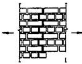
**Рисунок 2 - Растворение кладки по перевязанному сечению**
