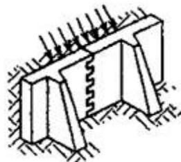
**Рисунок 3 - Растворение кладки при изгибе по перевязанному сечению**
